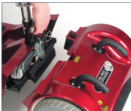
Sistema di smontaggio Sterling ® del sedile, veloce e senza fili o connessioni
